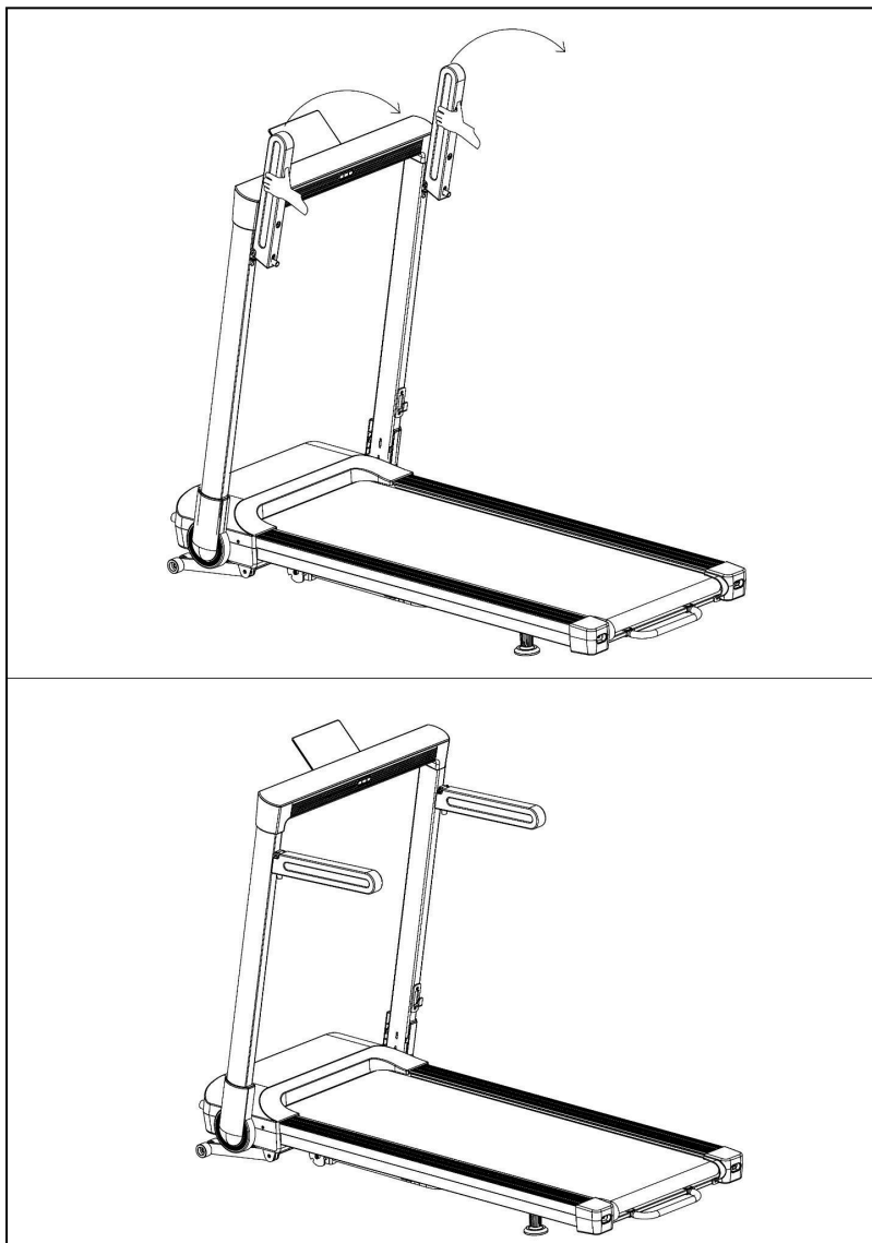
Рисунок 15 — Схема опускания поручней
